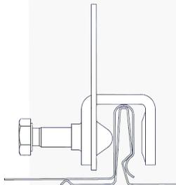
BEI STEHFALZ CLIP SYSTEMEN IST DIE MUTTERSCHRAUBE AUF DER VOLLEN SEITE DES FALZES. (SIEHE ABBILDUNG).
