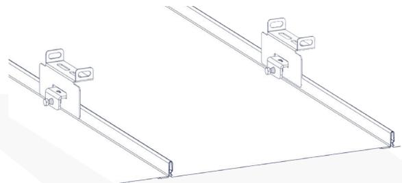
DIE HALTERUNGEN WERDEN AUF DEM FALZ MIT EINEM KLEMMPROFIL BEFESTIGT. DAS KLEMMPROFIL WIRD DURCH DIE RECHTECKIGE ÖFFNUNG DER HALTERUNG GESCHOBEN.
