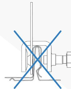
BEIM CLIP SYSTEM IST DIE MUTTERSCHRAUBE IMMER AUF DER SEITE DER DACHBEFESTIGUNG. (SIEHE ABBILDUNG).
